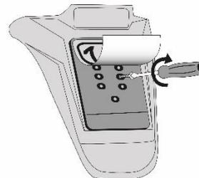
Schrauben Sie nun die Trägerplatte am Fahrzeug fest. Hierfür stehen Ihnen mehrere vorgebohrte Löcher zur Verfügung.
